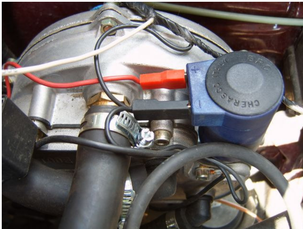
Газов клапан. с означени изводи. /+12V и маса/
